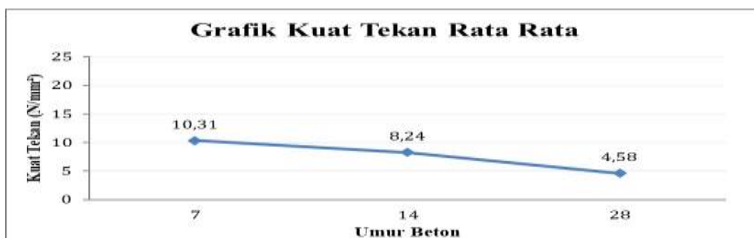
Gambar 5 Grafik Perbandingan Hubungan Nilai Kuat Tekan Beton Terhadap Umur Beton Variasi 10% TKKS
